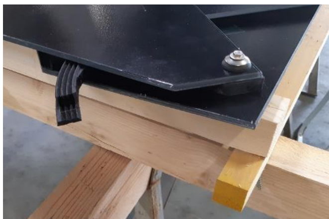
Figure 3 : Ancre d'étanchéité (17) dépassant côté gauche
